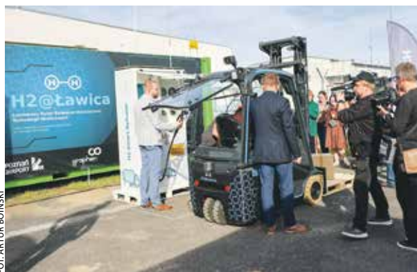
Na terenie terminala cargo poznańskiego lotniska testowane są wózki widłowe zasilane produkowanym na miejscu wodorem.
